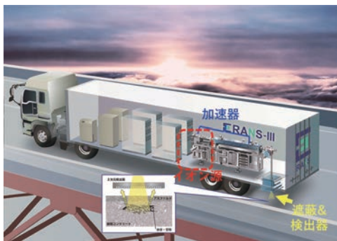
可搬型小型中性子源システム RANS-III (本文 45 ページ)
