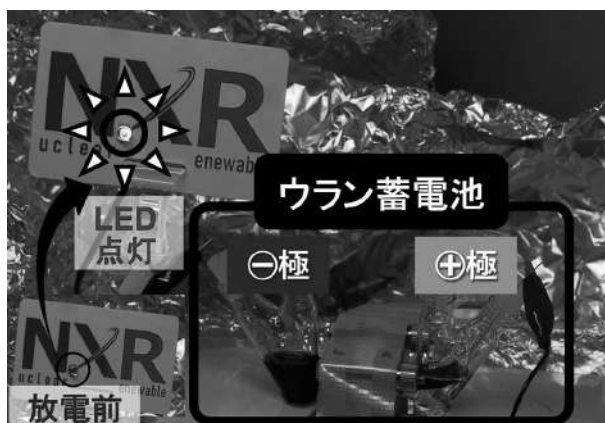
図5 ウラン蓄電池によるLED点灯試験
