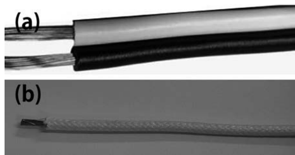
図 5. ケーブルの耐熱温度、(a) KIV ケーブル：60℃、(b) シリカガラス耐熱線（NSBL 電線）：400℃＝写真提供：山田武
