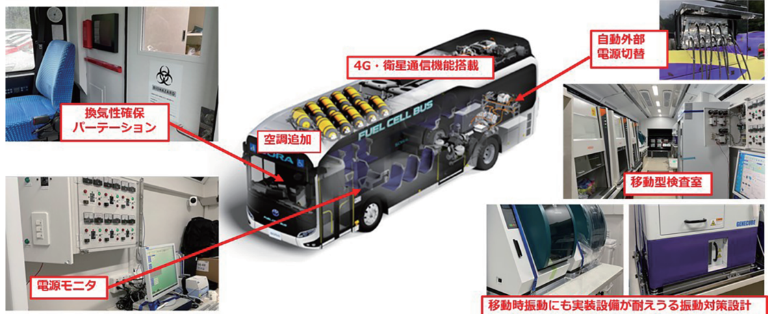
PCR 検査が可能な水素燃料電池バスを用いた感染症検査モビリティの内部 (本文 4 ページ)
