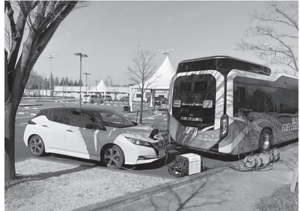
図9 臨時検査場において、大雪予報で水素ステーションでの水素充填ができなくなる事に備え、電気自動車から給電を受ける様子
