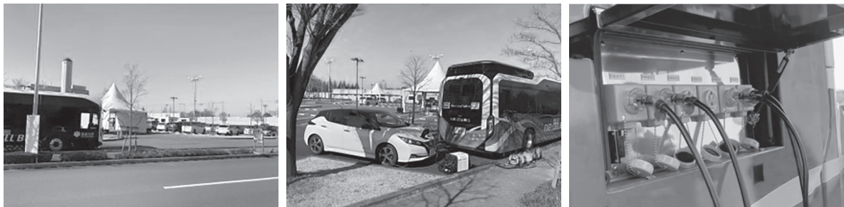
図4 臨時検査場④において、電気自動車から給電を受ける様子④ 福祉避難所への電力供給の様子④
