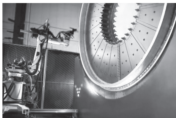
3D プリンタによる製造 円形部分が回転し、衛星格納部分と思われる部品が additive manufacturing (積層造形) により成型されていく。初号機は 3D プリンタ部品重量比約 85% 達成 (Relativity 社 HP より)
